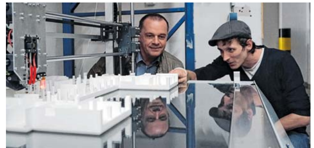
Thomas Schubert (l.) vom TeGeCe und Mario Kuntzag am 3-D-Drucker. Für ein Gebäude-Modell wird jedes Stockwerk anhand der Baupläne einzeln angefertigt.
